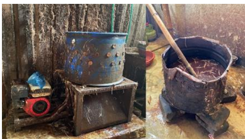
Gambar 1. Alat Pencabut Bulu Ayam dan Tungku Perebusan
